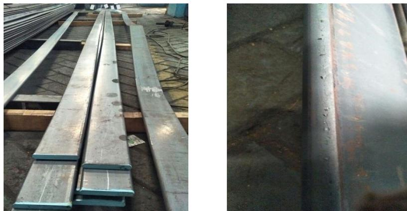
Gambar 1.2 Produk *Defect Bending* dan *Scratch* (Sumber Data Perusahaan)
