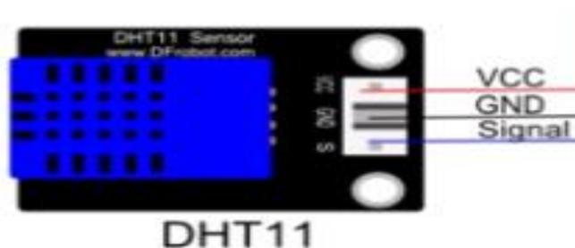
Gambar 2.13 Sensor kelembapan dan suhu (DHT-11)
