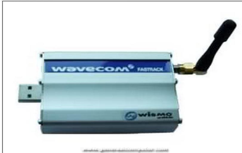
**Gambar 4.** Modem Wavecom (M1206B-Q2406B)(Ario, 2002).
