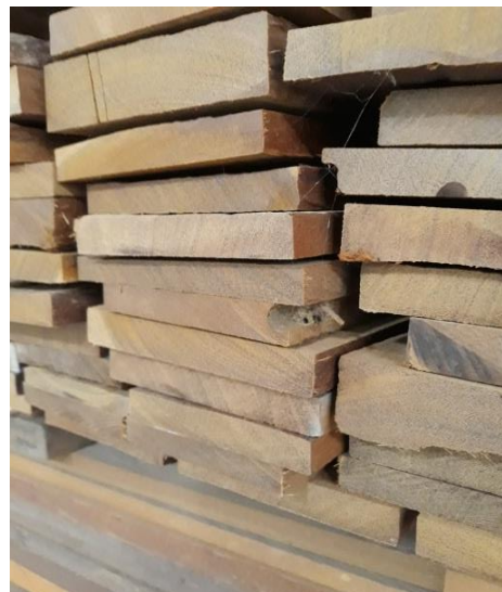
Gambar 1.2 Contoh Produk Reject Busuk dan retak (Sumber : Data Perusahaan)
