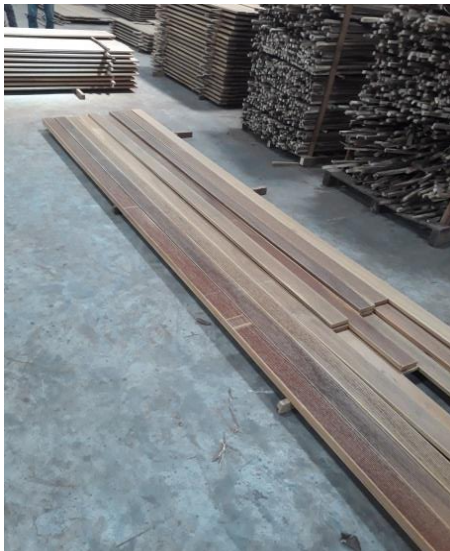
Gambar 1.2 Contoh Produk Reject Busuk dan retak (Sumber : Data Perusahaan)
