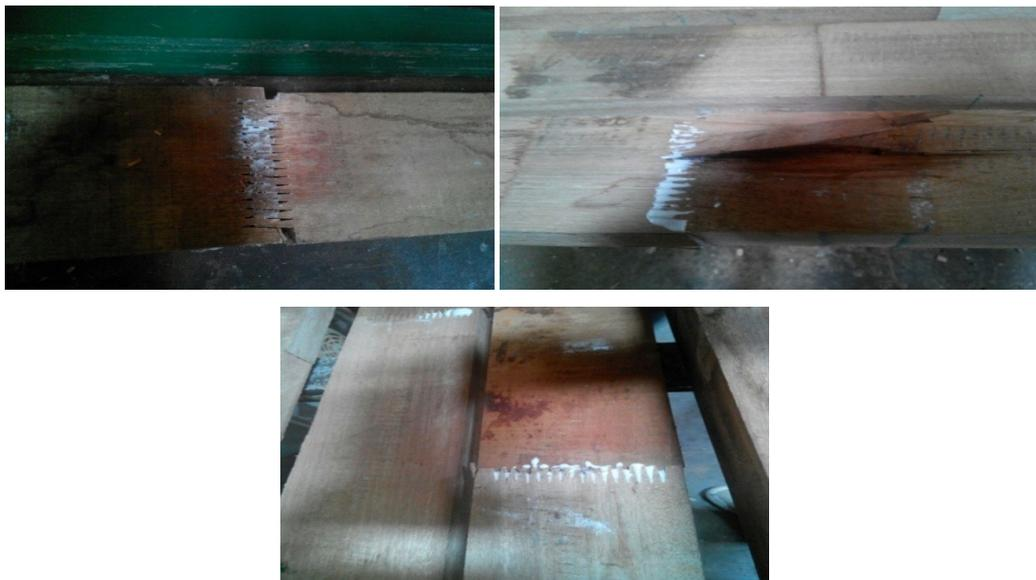
Gambar 1.1 *Defect* Sambungan Renggang, Pecah, Warna Tidak Sama
