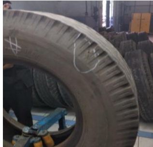
Gambar 2.18 Pemberian tanda cacat pada ban
