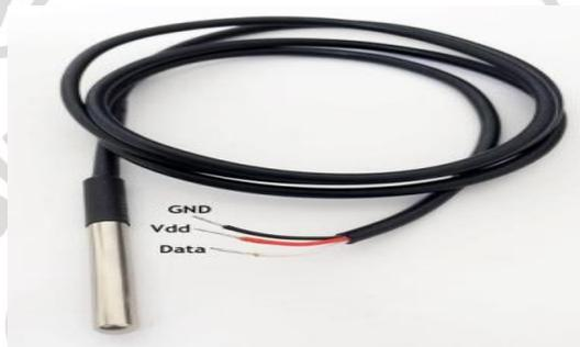
**Gambar 2.5**DS18B20 (Sensor Suhu Udara)
