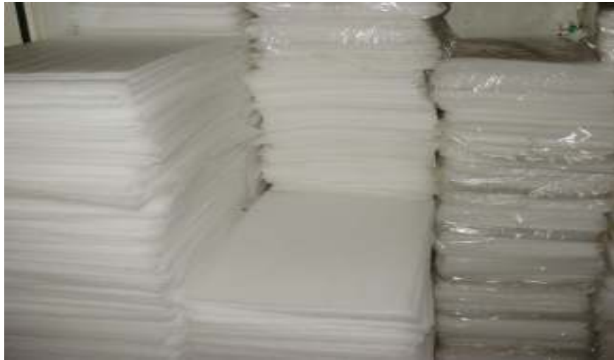
Gambar 5.2 PE FOAM Untuk melapisi komponen sheet saat ditumpuk
