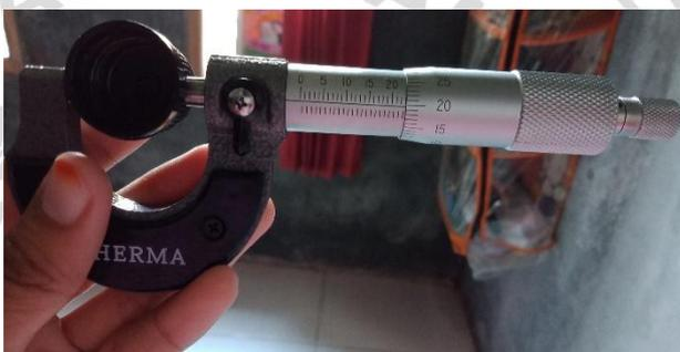
**Gambar 2.3 Mikrometer Sekrup**
