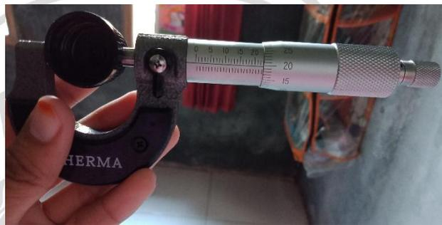
**Gambar 2.3 Mikrometer Sekrup**
