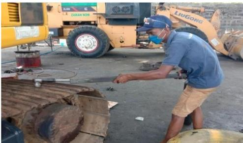
Tahap 7 : Kuati menggunakan kunci stank L shock 27 dan stank pipa
