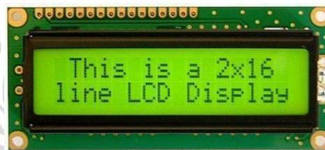
Gambar 2.14 lcd display
