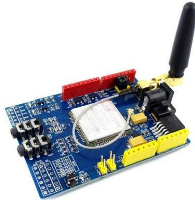
**Gambar 2. 15 GSM Module SIM900**
