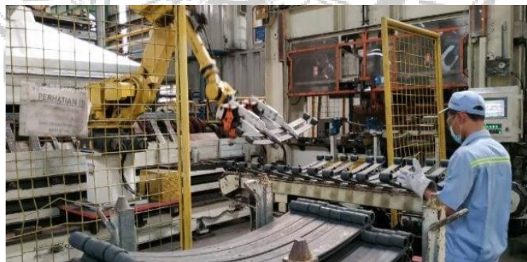
Gambar 2.7 Proses Pengangkatan Leaf Spring Setelah Didinginkan
