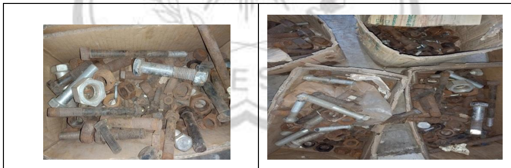
Gambar 1.1 Penyimpanan Mur baut berbeda ukuran dan jenis dicampur jadi satu yang terlihat tidak rapi
