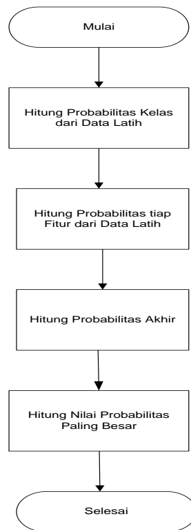
Gambar 3.3 Flowchart Penjelasan Perhitungan Probabilitas Kelas Menggunakan Naive Bayes
