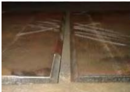
Gambar 3.4 Material dengan kampuh V 30^{\circ}
