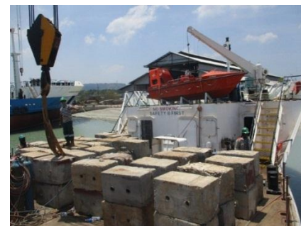
Gambar 18. Uji pembebanan deck dok trial
