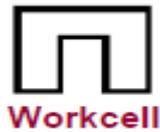
Symbol ini menunjukkan bahwa beberapa proses terintegrasi dalam sel kerja manufacture. Sel-sel semacam itu biasanya memproses keluarga terbatas produk sejenis atau produk tunggal. Produk bergerak dari langkah proses dalam batch kecil atau potongan tunggal.
