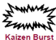
Ikon ini digunakan untuk menyoroti kebutuhan perbaikan dan merencanakan ruang kerja kaizen pada proses spesifik yang penting untuk mencapai *Future State Map* dari *value stream*.
