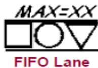
Inventaris *first-in-first-out*. Gunakan ikon ini saat proses dihubungkan dengan system FIFO yang membatasi masukan. Sebuah *roller conveyor* yang terakumulasi adalah sebuah contoh. Catatlah persediaan maksimum yang mungkin.
