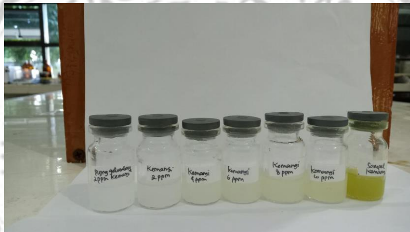
Gambar 6.5.9 Larutan standar dan sampel untuk pengujian Spektrofotometri UV-Vis
