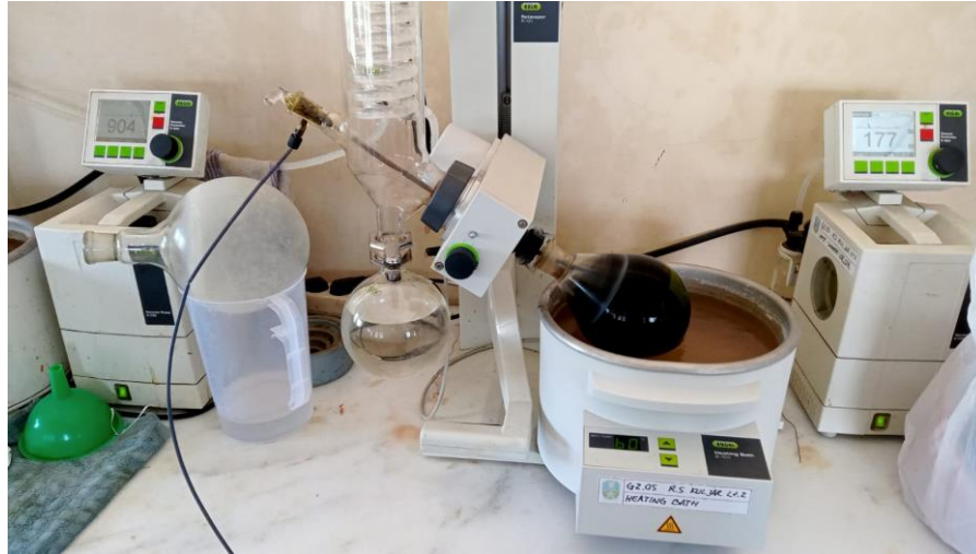
Gambar 6.3.1 Pemekatan ekstrak dengan rotary
