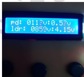
Gambar 4. 14 tampilan adc ketika sensor terkena cahaya
