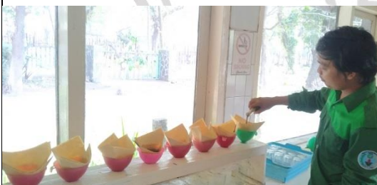
Proses penuangan nira yang tercampur form A dan form B kedalam masing-masing corong tapis yang terdapat pada rak
