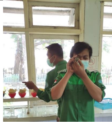
Menentukan kadar brix tebu dengan menggunakan alat refraktometer dan meneteskan larutan kedalam prisma hand refraktometer dan dibaca skala brix
