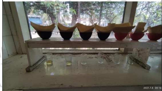
Rak-rak untuk menampung hasil pentapisan untuk menyaring nira tebu yang sudah di campur form A dan B bertujuan mendapatkan nilai pol
