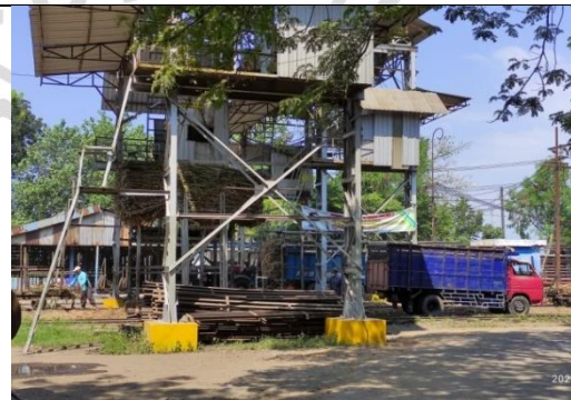
Timbangan tebu merupakan peralatan yang sangat penting untuk pabrik gula untuk mengetahui berat atau bobot tebu
