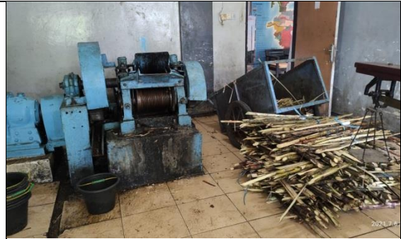
Alat penggiling tebu atau pemeras tebu yang digunakan untuk membantu penggiling tebu untuk mengambil sarinya
