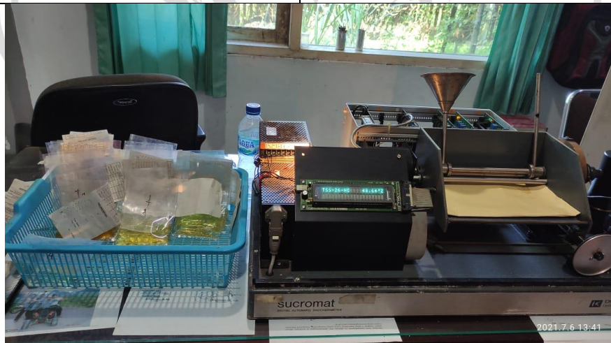
Alat polarimeter adalah alat yang digunakan putaran optik yang di hasilkan oleh suatu zat yang bersifat optis aktif yang terdapat pada larutan
