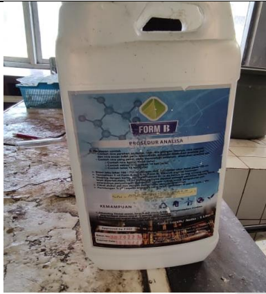
Form B larutan digunakan untuk bahan penjernih dalam analisis pol
