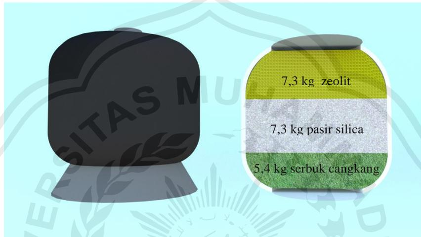
**Gambar 6.** Susunan filter serbuk cangkang kerang hijau
