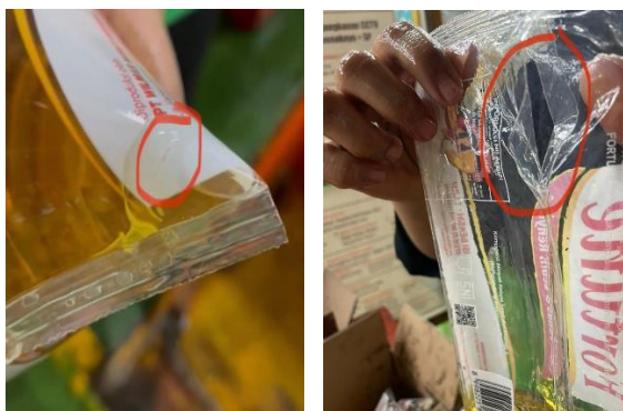
Gambar 2. Leaking badan (kiri), dan vertikal (kanan)
