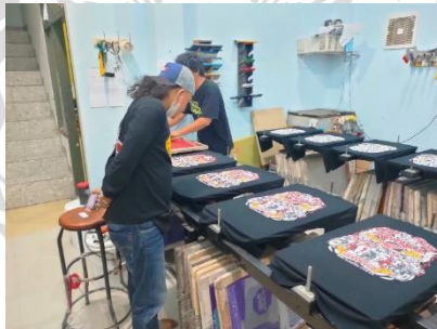
Gambar 8. 6 Pengecekan hasil sablon manual
