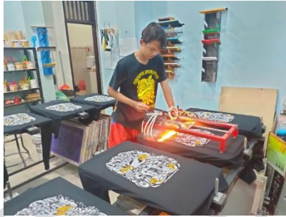
Gambar 8. 5 Pengeringan sablon manual
