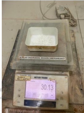
Gambar 2. 8 Proses penimbangan sampel pengujian Lolos Mesh 100
