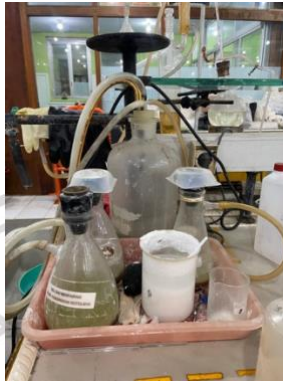
Gambar 2. 7 Proses penyaringan pada sampel kapur
