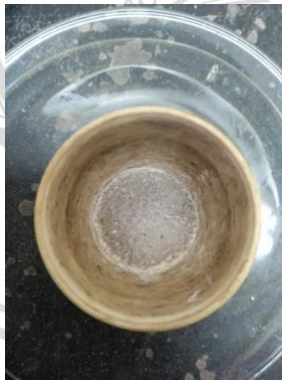
Gambar 2. 9 Hasil penyaringan sampel kapur lolos mesh 100
