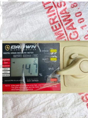
Gambar 22. Pengukuran Kadar Air Gabah Kering Giling
