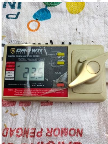
Gambar 21. Pengukuran Kadar Air Gabah Kering Panen
