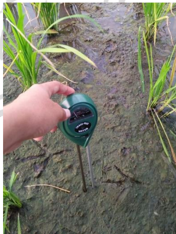
Gambar 18. Pengukuran pH Tanah
