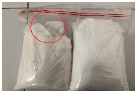
Gambar 7. Sampel produk cacat mamel pada garam halus yodium, kiri (garam mamel) dan kanan (garam kualitas baik)
